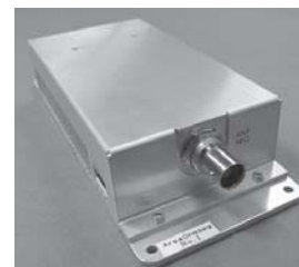
写真 エリアワンセグモジュール (OFDM変調/RFモジュール)
