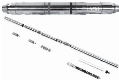
写真2 津波計 (防災科学技術研究所)
