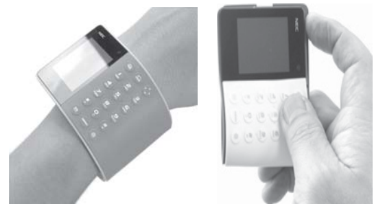
図6 形状記憶性ポリ乳酸複合材を用いたウェアラブル端末モデル
