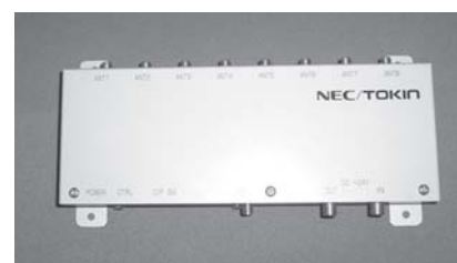
写真2 アンテナスイッチBOX外観
