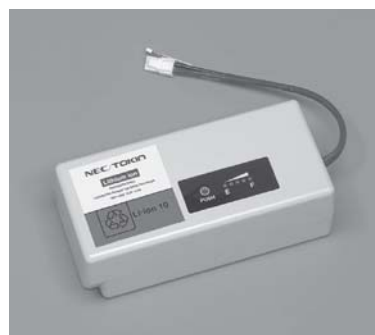
写真2 7直列1並列タイプ標準電池パックの外観
