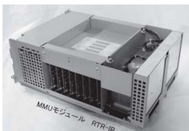
写真4 RTRモジュール
