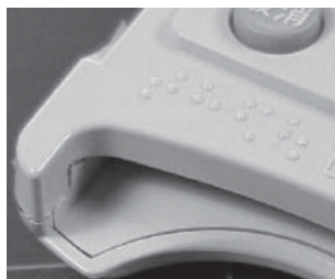
写真5 カード挿入口が見えるためスキミング装置がある場合一目でわかる
