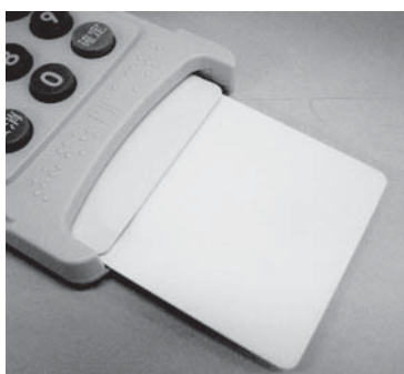
写真3 ICカードを2枚挿入できなくしている
