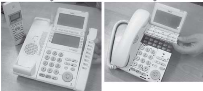
写真2 モジュール合体式の構造
