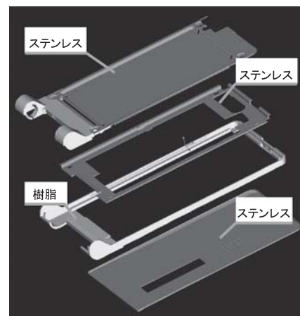
図3 本先行試作機のハイブリッド筐体
