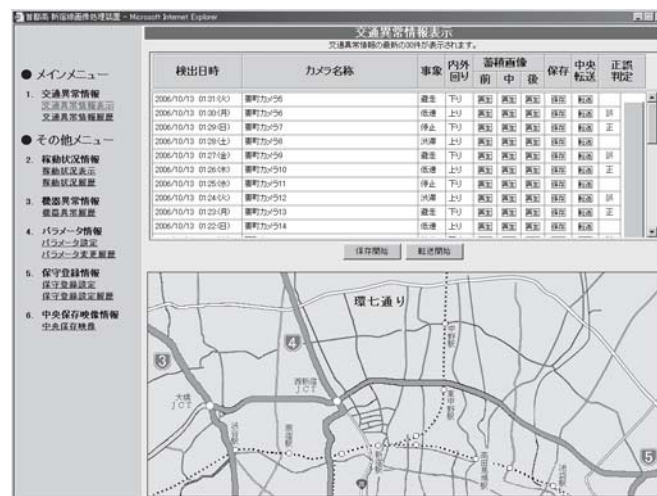
図2 交通異常検出装置 操作画面
