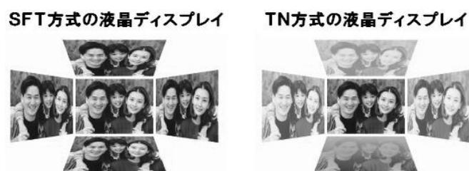
図3 SFT方式とTN方式の見え方の違い
