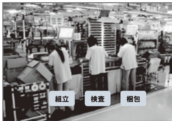
図2 RFIDを活用したパソコン生産ライン
