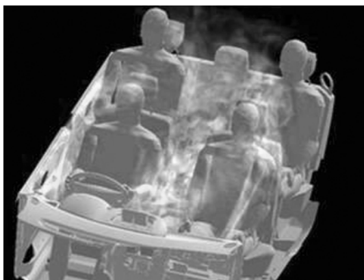
図7 空調による車室内の温度分布（日産自動車との共同研究）
