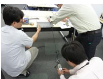
電源コード固定の強度試験
