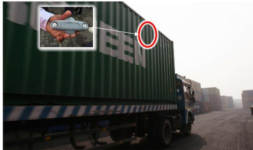
コンテナに磁石で簡単に取り付けられる RFID
