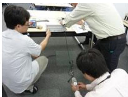
電源コード固定の強度試験
