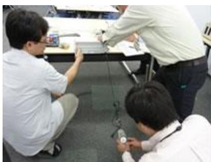
電源コード固定の強度試験
