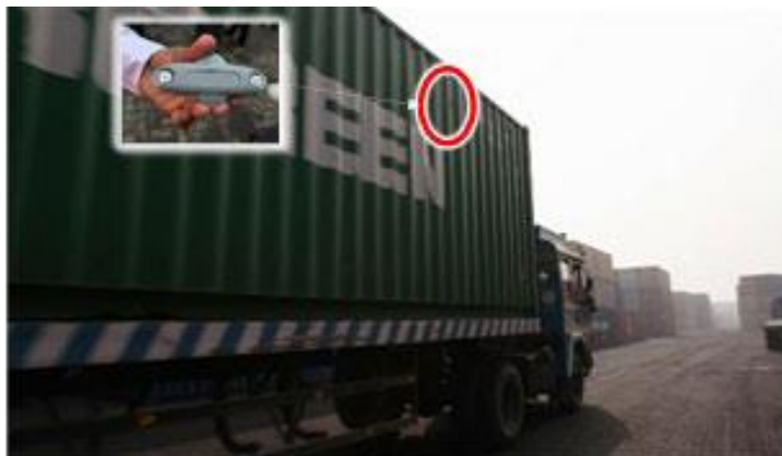
【コンテナに磁石で簡単に取り付けられるRFID】
