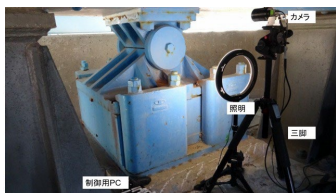
ピンローラー支承 計測時の機材配置
