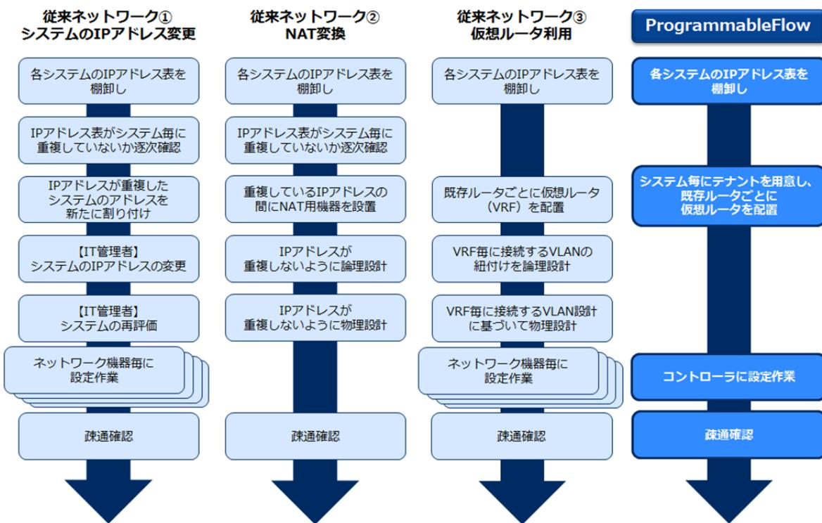
複数の業務システムのネットワークを集約する場合では、システムの IP アドレスが重複するケースがあります。こうした場合、従来のネットワーク技術では、どちらかのシステムの IP アドレスを変更するか、NAT（アドレス変換）を用いて重複を解消する必要があり、いずれにしてもシステム移行作業が複雑になりました。ProgrammableFlow では各システムを VTN に分けて収容することができるため、相互に独立した VTN によってアドレス空間を分離して、IP アドレスが重複したシステムの統合も簡単に実現することができます。
