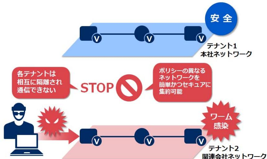
VTN は相互に隔離され、VTN 間の通信はできません。そのため、セキュアにかつ簡単にネットワークの集約が可能になります。例えば複数の顧客のネットワークを集約するケースにおいて、一方のネットワークからのワーム感染なども、VTN を利用して感染したネットワークを隔離することで相互の侵入を遮断し、セキュリティを確保できます。
