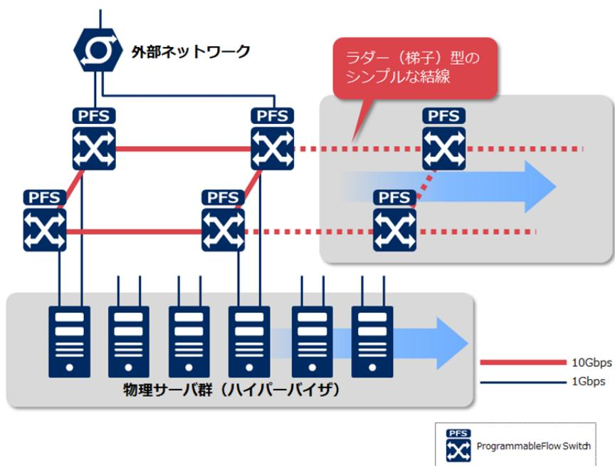
データセンターの移設やシステム統合において、ネットワークをスケールアウト型で構成することにより、初期費を抑制し、システムの拡大に合わせてネットワークを柔軟に拡張することができます。比較的小規模な仮想化基盤のネットワークにおいて用いられるラダー型のトポロジは、スケールアウト型のシンプルなネットワーク構成を実現できる上、機器間の煩雑な接続ケーブルの削減にもつながります。
