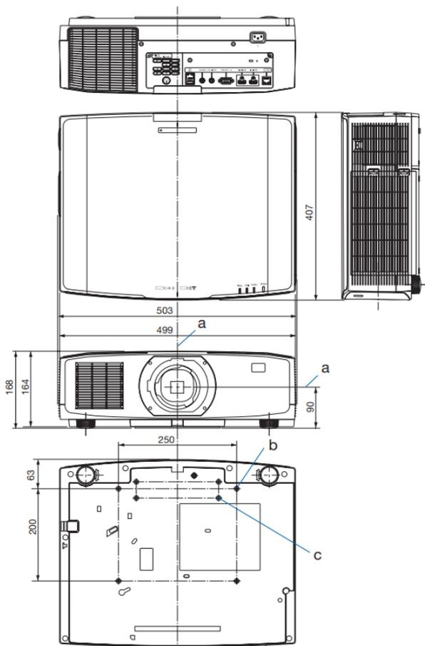
a: レンズ中心 / b: 天吊り金具取り付け用ネジ穴 / c: NP50ZL サポートキット取り付け用ネジ穴
