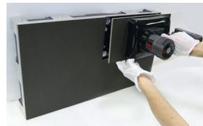
ピクセルカードの脱着やメンテナンスは、前面で作業可能。
