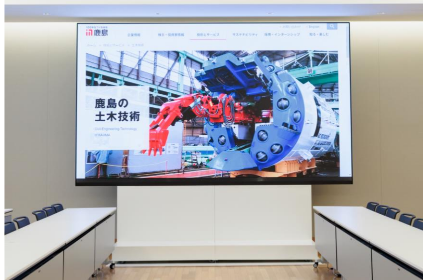
165型LEDディスプレイマルチスクリーン LEDディスプレイにはベゼル(枠)が無く、シームレスな大画面の構築が可能
