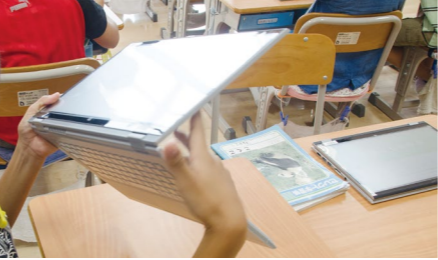
■キーボードは360度開閉機構により、ノートPCとしてもタブレットPCとしても使えます。
