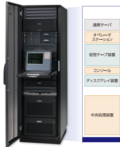
※図は19型サーバーラックへの搭載例です。搭載するモジュールはシステム構成により異なります。
