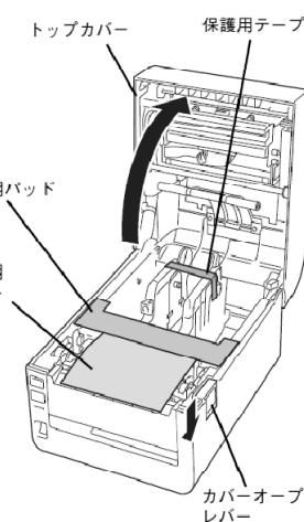
④トップカバーを両手で「カチッ」と音がするまで押して確実に閉めます。
