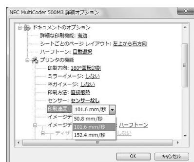
印刷速度を速くすれば、印刷作業もはかどり業務時間を短縮させることができます。使用する用紙や印刷データの内容によっては印刷位置のずれやかすれなど印刷品質に問題が起きことがあります。万一、印刷品質に問題がある場合は、もう1段階印刷速度を遅くして印刷を試みてください。
