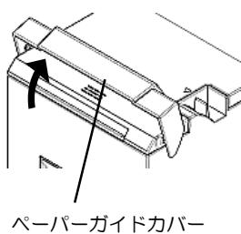
工場出荷時は、80mm幅用紙の設定となっています。50mm/58mm幅用紙を使用する場合は、MultiCoder 320S2DC ユーザーズマニュアル「5-3. 仕切り板の取り付け方法」を参照し仕切り板を取り付けた後にロール紙をセットしてください。
