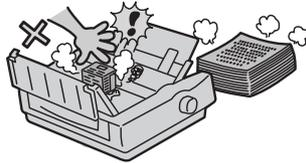
プリンタの内部には、使用中に高温になる印刷ヘッドという部品があります。カバーを開けて作業する場合は十分に冷めてから行ってください。使用中に触ると火傷するおそれがあります。
