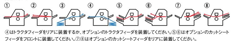
④はトラクタフィーダをリアに装着するか、オプションのトラクタフィーダを装着してください。⑤⑥はオプションのカットシートフィーダをフロントに装着してください。⑦⑧はオプションのカットシートフィーダをリアに装着してください。
