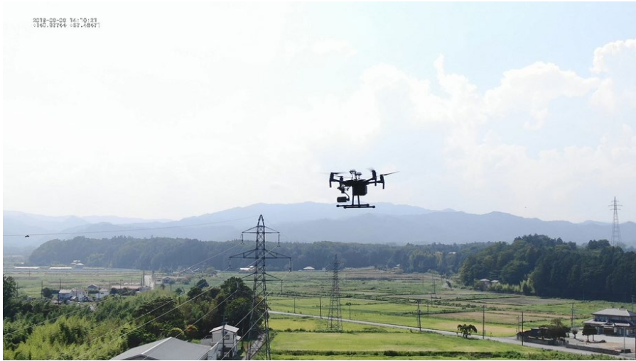
ドローンによる「送電線自動追尾点検」の実証実験の様子 (2019年7月～8月に、福島県内で実施)
