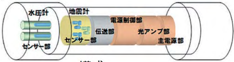
図3 観測装置の外観と構成 (観測装置は、NECで開発・製造)
