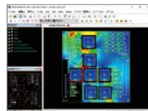
電流が集中している箇所をグラデーションで表示
