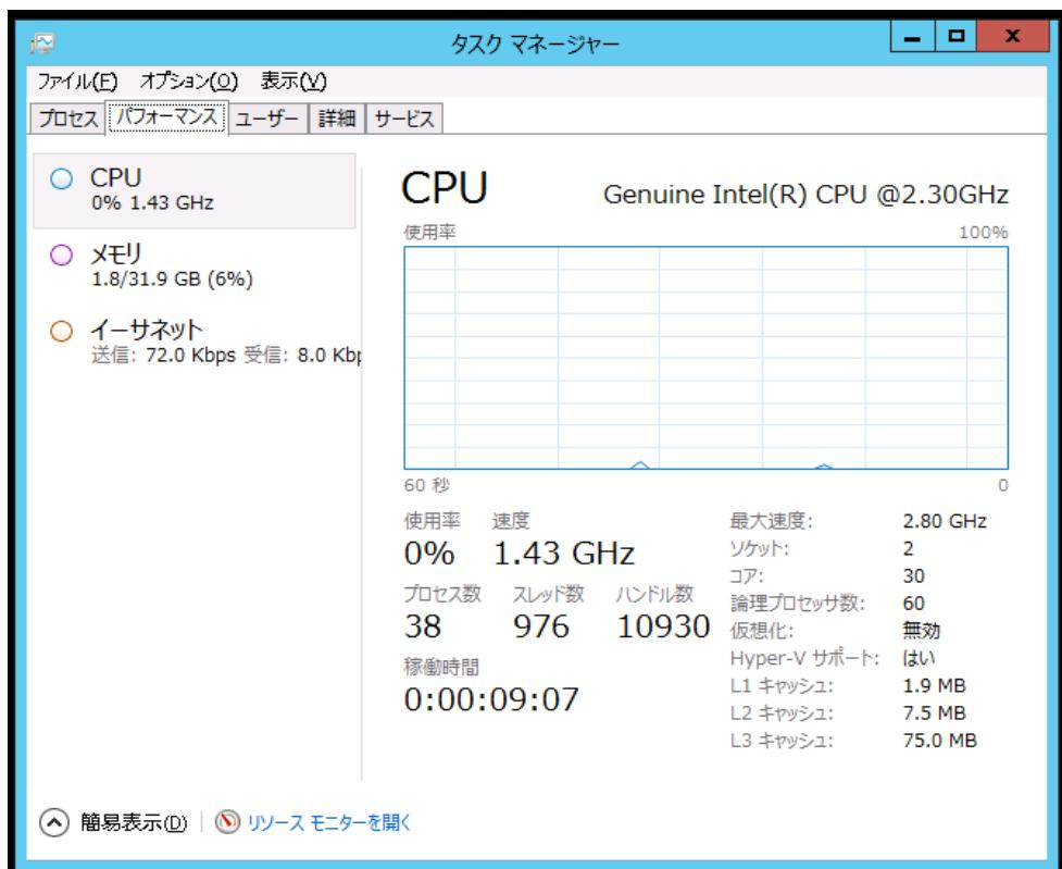
コアに表示されている数が、コア有効化後の有効コア数と一致していることを確認してください。また、Hyper-Threading が有効な場合は、論理プロセッサー数が、コア有効化後の有効コア数の 2 倍の数と一致していることを確認してください。Hyper-Threading が無効な場合は、論理プロセッサー数が、コア有効化後の有効コア数の数と一致していることを確認してください。
