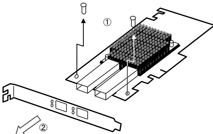
3. ロープロファイルブラケットを本製品に取り付け(①)、ネジ(2本)で固定します(②)。
