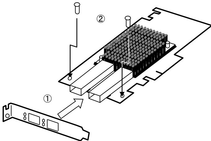
4. 1. で取り外した SFP+モジュールを取り付けます。
