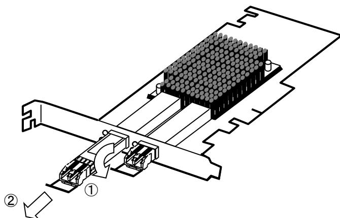
4. 本体装置のユーザーズガイドに従って PCI スロットへ本製品を取り付けます。
