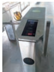
キャッシュレスでの運賃収受を実現する 「自動料金収受システム」
