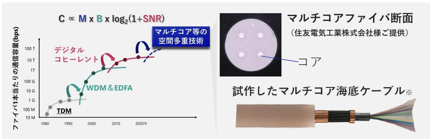
コア間の信号干渉が小さい非結合型マルチコアファイバに、独自の伝送技術を適用しさらに干渉を抑制することで、海洋の長距離でも大容量を通信可能な128コアの光ファイバケーブルを実現
