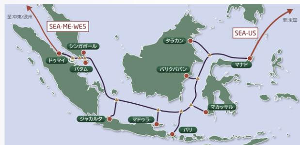
システムが完成した暁には、同じくNECが手掛けた、インドネシアから米国を結ぶ「SEA-US」や、シンガポールから中東を経由してヨーロッパを結ぶ「SEA-ME-WE5」など、他の大容量光海底ケーブルに接続する予定です。インドネシア国内の通信ネットワーク充実に加え、同国の国際通信ネットワーク拡充および国際通信における通信ハブ化に貢献します。
