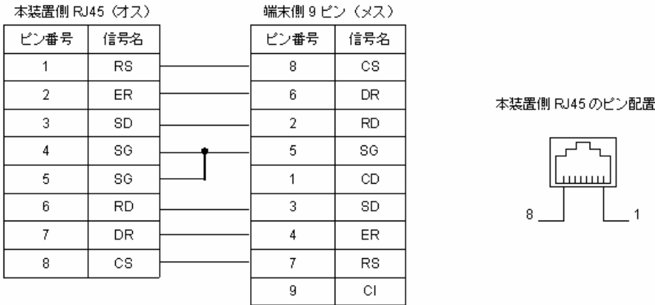
図 1-2 RS-232C クロスケーブルのピン配置
