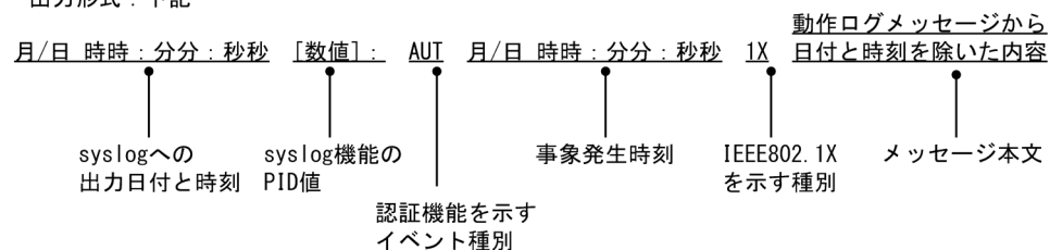
図 6-3 syslog サーバへの出力形式
