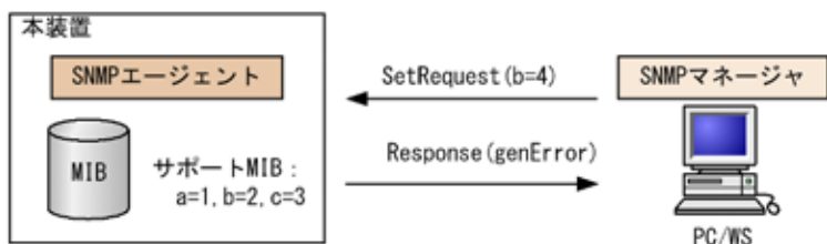
図 20-22 装置の状態によって設定できない場合の SetRequest オペレーション
