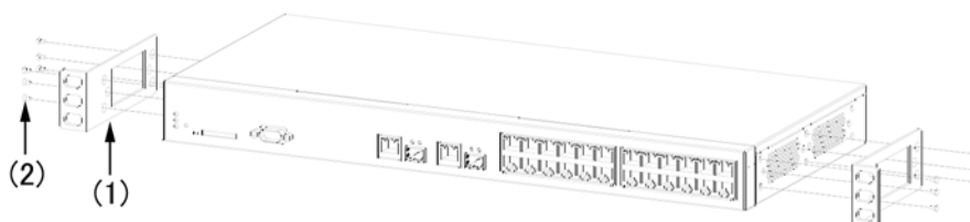
図 4-9 ラック固定金具の取り付け（IP8800/SS1250 および IP8800/SS1240）
