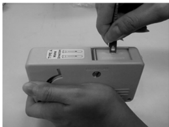
図 A-5 フェルール端面の清掃
