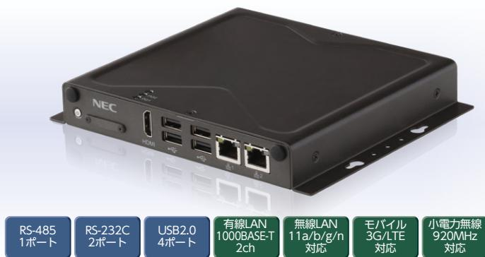
各種センサーのデータやカメラで撮影した映像データなどを、まとめて1ヶ所で収集するのが小型IoTゲートウェイ端末「エッジゲートウェイ」です。ネットワーク経由で本製品にアクセスすることでリアルタイムにデータを取得することができます。各種データはシリアル、USB、有線 / 無線LANといったさまざまなインターフェースを介して収集が可能。NEC独自のセキュリティ機能により、データを取得する機器やデータを参照する機器を制限できますので、情報漏えいリスクを軽減しつつ、収集したデータを利用できます。
