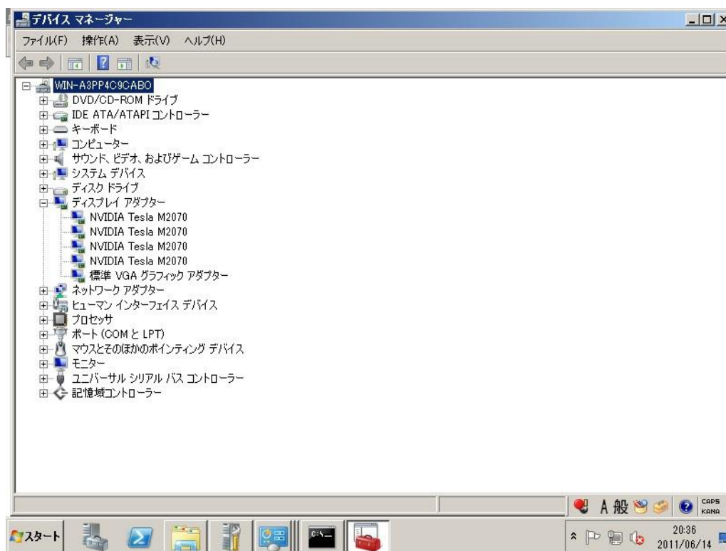
ドライバをインストールすると、Tesla M2070 が4つ認識される。
