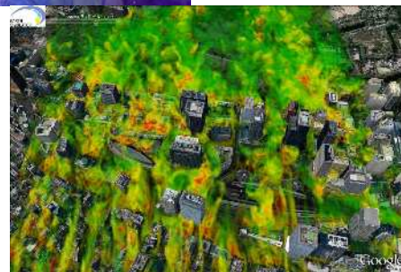
右図： 大手町周辺の 気流と気温の シミュレーション
