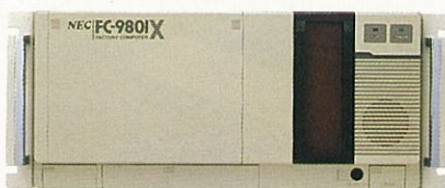
model 1:RAMファイル(1Mバイトタイプフロッピーディスク相当)を内蔵 model 21:20Mバイトタイプの3.5インチ固定ディスクを内蔵
