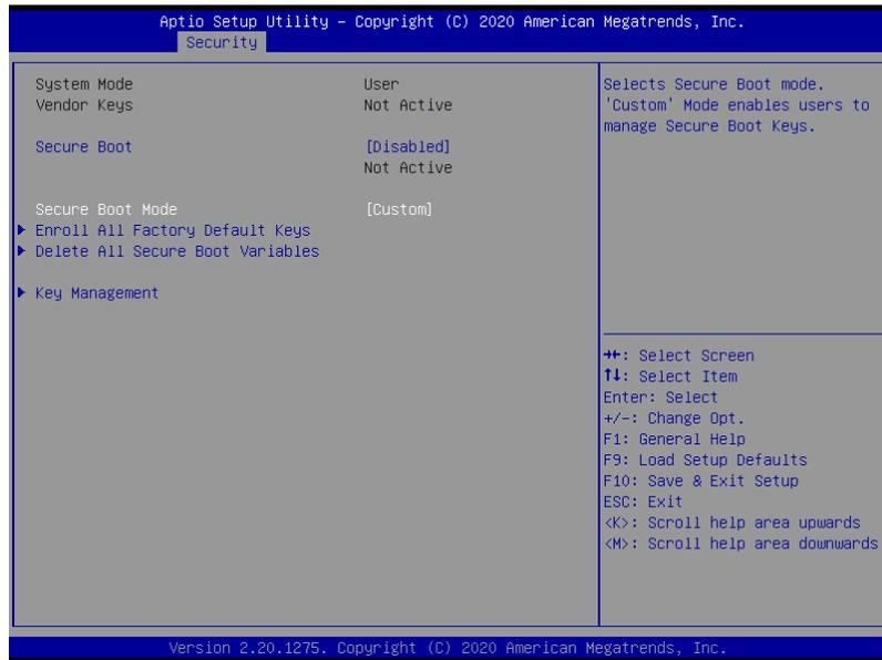
注) 『Secure Boot Mode』が選択不可の場合、<ESC>キーを押下して『Security』画面に戻り、『Administrator Password』に任意のパスワードを設定してください。設定したパスワードは忘れないようにしてください。その後、再度『Secure Boot menu』を選択してください。
