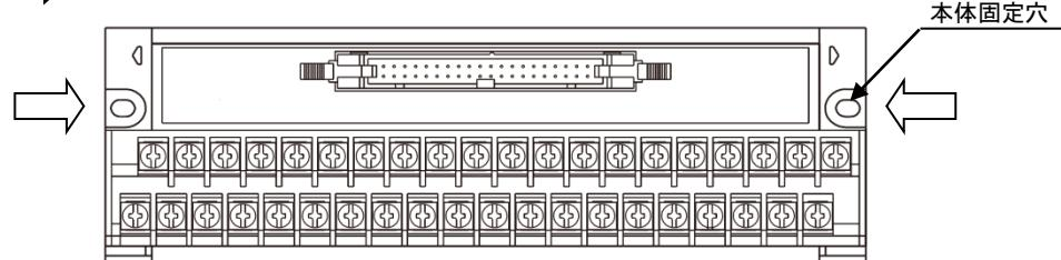
端子台を固定するネジ穴は、下記寸法のように加工してください。
