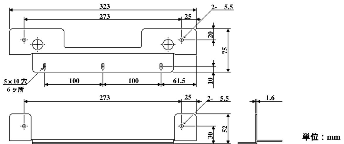
本体固定金具(FC-RK004)装着 平置き設置時 外形寸法図
