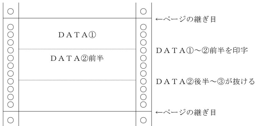
図 4-12 印字結果(印字中の永久障害)
